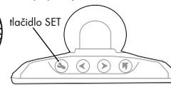
Pri zapnutom zapalovaní zaradíte spiatocku. Stlačte tlačidlo SET na dve sekundy, uvoľnite a po jednej sekunde ho opäť stlačte pre zapnutie/vypnutie hlasovej signalizácie.
