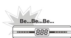
Systém detekoval vadný snímač. Bzučiak pípne 3x a na displeji sa zobrazí číslo vadného snímača (E1-E4). Ostatné snímače fungujú normálne.
