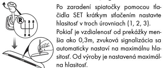
Po zaradení spriatočky pomocou tlačidla SET krátkym stlačením nastavte hlasitosť v troch úrovniach (1, 2, 3). Pokiaľ je vzdialenosť od prekážky menšia ako 0,3m, zvuková signalizácia sa automaticky nastaví na maximálnu hlasitosť. Od výroby je nastavená maximálna hlasitosť.
