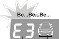
Systém detekoval vadný snímač. Bzučiak pípne 3x a na displeji sa zobrazí číslo vadného snímača. Ostatné snímače fungujú normálne.
