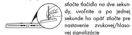
stlačte tlačidlo na dve sekundy, uvoľnite a po jednej sekunde ho opäť stlačte pre nastavenie zvukovej/hlasovej signalizácie
