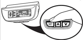
Pri zapnutom zapalovaní zaradíte spriatočku. Stlačte jedenkrát tlačidlo SET pre zapnutie/vypnutie hlasovej signalizácie.
